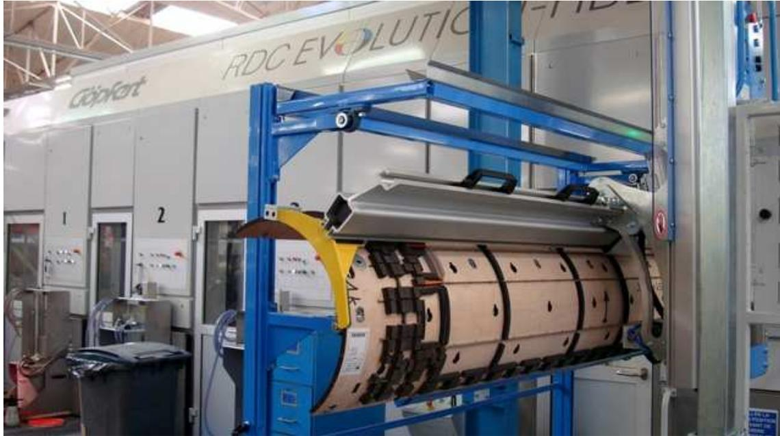
Le Mobilator pour outils de découpe rotative de BCM, a été développé en coopération avec les leaders de la fabrication de formes de découpe et de la transformation du carton en Europe. Grâce au Mobilator pour formes de découpe rotative, l'opérateur peut à présent prendre la forme de découpe directement depuis le chariot de transport, et le placer directement sur la machine sans avoir d'objets lourds à lever.
