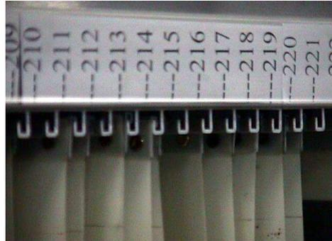
Le système de rangement de BCM est livré avec deux types différents de profils standard: l'un pour les clichés avec barre en L, l'autre pour les clichés avec une barre en T (barre plastique rectangulaire).
