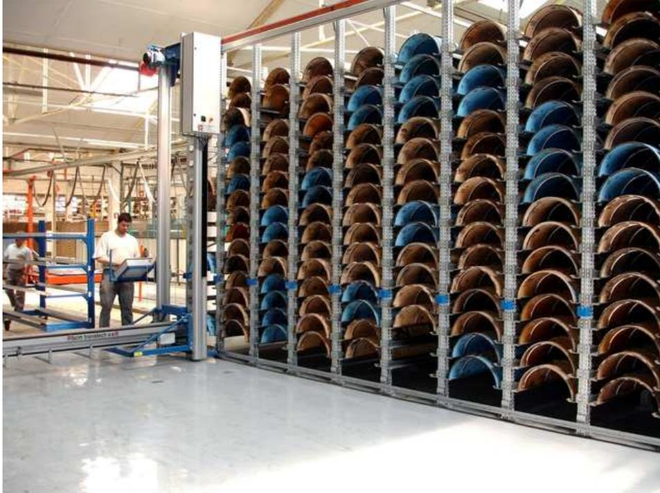
BCM propose une gamme complète de système de rangement et de manipulation pour les outils de découpe rotative. Le système de racks est modulaire et adapté aux différents diamètres et longueurs des outils.
