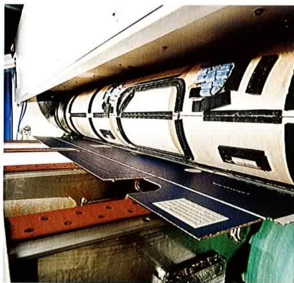
Les formes de décarpe peuvent être installés sans interrompre la production. Le décortiqueur (en option) accroît la productivité de la chaîne lorsqu'elle comprend un poste de découpage.
