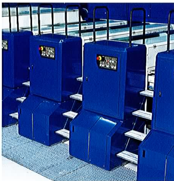
Postes d'impression recto avec système de transport à dépression, pour un respect absolu des tolérances de repérage.
