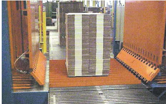
2 Arrêt en position de la pile et montée de la herse placée entre les rouleaux. Positioning of stack on rollers. Lifting of the stack by plates placed in-between the roller.
