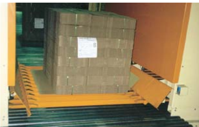
3 Centrage de la pile et repli des protections inférieures lors de la fermeture des panneaux latéraux. Stack centring and folding of bottom protections during closing movement of side plates.
