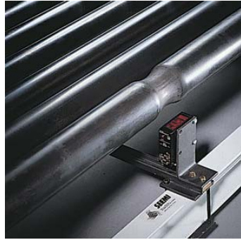
Cellule sous les rouleaux avec rouleau encoché Photocell under rollers with a notched roller
