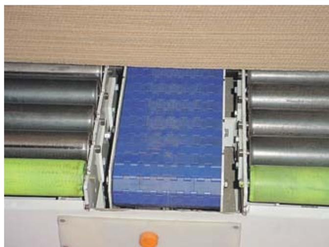
*Ligne de stockage équipée d'une bande centrale plastique motorisée et débrayable pour accumulation jointive des piles.*
