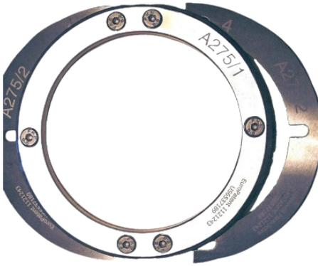
La circonférence polygonale des profils de refoulage MaxxScore permet d'obtenir un refoulage proche de celui obtenu avec une découpe à plat:
