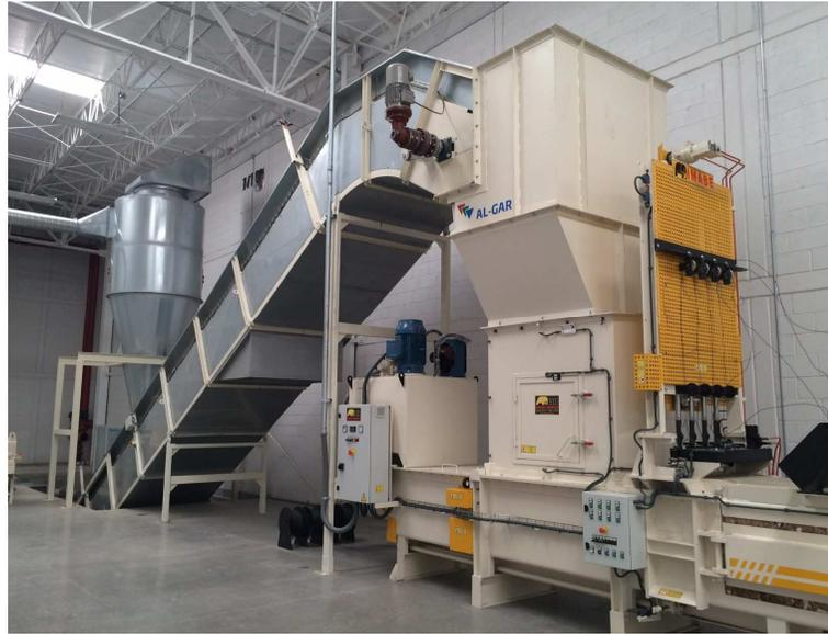
Le carrousel à ailettes peut être combiné avec un électro-ventilateur qui découpe et envoie le matériel jusqu'au cyclone/séparateur ou avec un convoyeur incliné pour transporter les découpes jusqu'à l'emballageuse.
